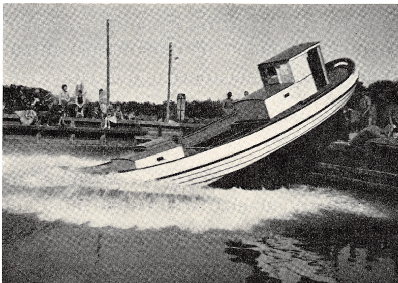
Fiskebåd »Vira« under søsætningen i Fejø havn, idet den tager vandet. Søsætningen sker altid med forstævnen forefter, da den største vægt ligger agter. Fot. fru skibslører Christensen.
