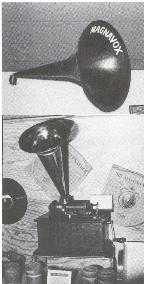
Øverst: Falstringen Peter L. Jensens magnavox »Den store stemme«, som den ses ophængt under loftet. Nederst: Edisons fonograf fra ca. 1890 med valser. (Stubbekøbing Motorcykel- og Radiomuseum).
